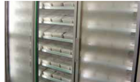
Zum Vergleich: Zwei Standard-Scheiben (links und rechts) sowie eine AF Antifog-Türscheibe (mittig), jeweils kurz nach einer Türöffnung im Versuchslabor fotografiert.
